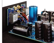
Über den Mundorf-Kondensator blicken Sie auf den Lundahl-Übertrager – die verwendeten Komponenten sind vom Feinsten
