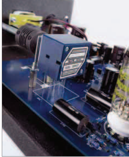
Ein mir gut bekanntes und geschätztes Poti von Alps kümmert sich um den Ausgangspegel
