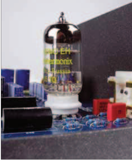
Die Ausgangsröhre vom Typ 12AT7WC kümmert sich um die finale Signalaufbereitung
